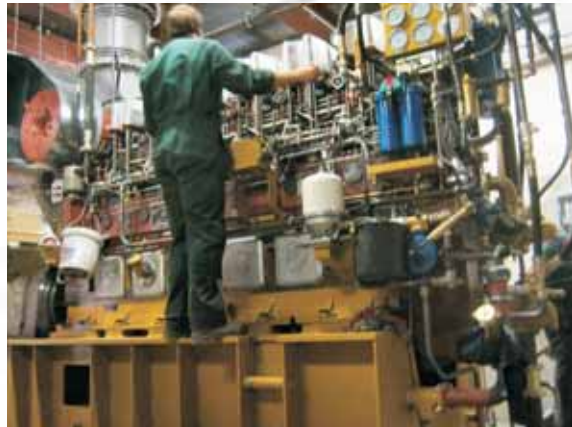
Ein 6-Zylinder-Motor beim ersten Probelauf
